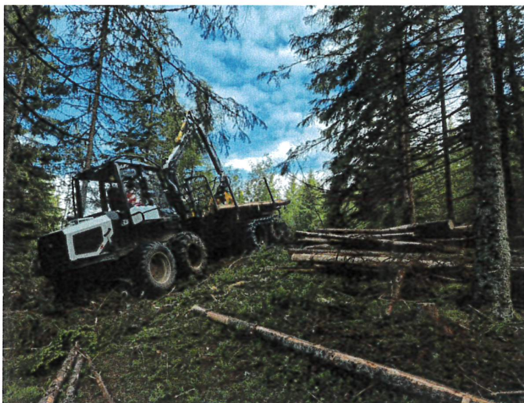
Skånsom tynning med bestandsgående mindre maskiner. Her Skog & Virke med Vimek lastbærer.
